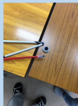
壊れた折りたたみ式の白杖。先端のキャップが外れた上、つなぎ目が割れている＝2019年7月3日撮影（宮川純さん提供）
